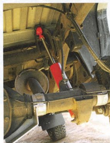
Bild oben: Portalachse und Fahrwerks-Höherlegung für mehr Bodenfreiheit
