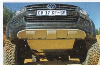
Funktion statt Show: massiver Unterfahrschutz, 17-Zoll-Stahlräder
